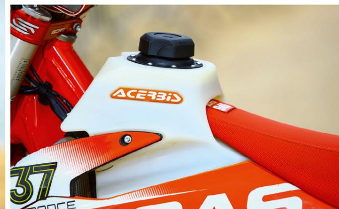
Pas de réservoir carbone spécialement conçu pour s'adapter à la GasGas, mais un modèle grande contenance de 12 litres en plastique de chez Acerbis.
