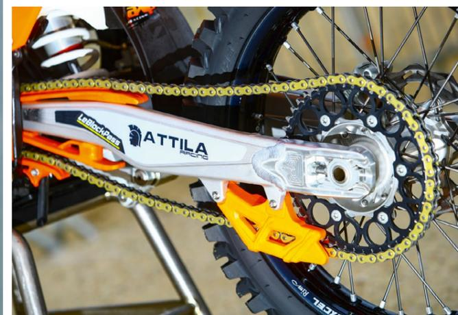
La 450 SX-F d'Alexis Collignon reçoit plusieurs éléments de qualité. Ligne complète HGS sur mesure pour booster les performances du moteur. On retrouve un bras oscillant rallongé, un guide-chaîne renforcé, carter Attila Racing, repose-pieds spéciaux, rien n'a été laissé au hasard.
