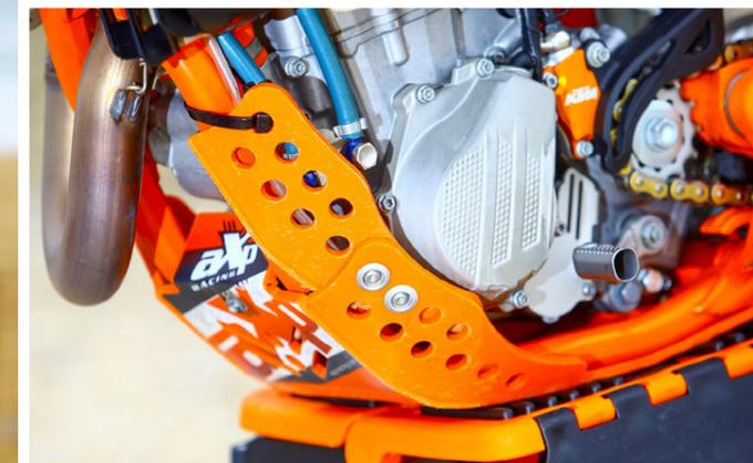
Gros plan sur le sabot plastique AXP idéal pour protéger le bloc-moteur. On aperçoit également le sélecteur et des protections supplémentaires pour le cadre.
