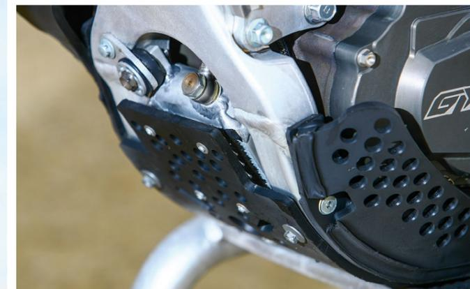
Gros plan sur le sabot moteur en plastique AXP monté sur le cadre de l'YZ-F Drag'on. Il protège le réservoir d'huile supplémentaire fixé juste derrière !
