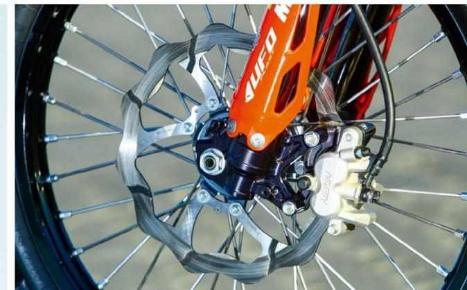
Gros plan sur le disque de frein avant oversize Galfer pris dans un étrier d'origine Nissin. Les plaquettes utilisées par le team sont de la même marque que le disque.
