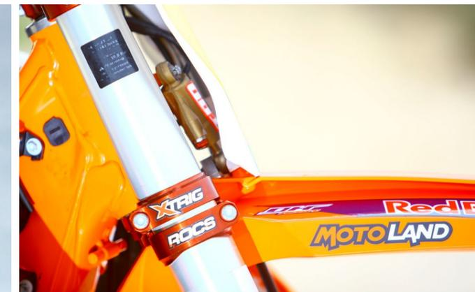
Équipée d'une fourche WP cone valve, la KTM d'Hauquier dispose aussi de tés XTrig ROCS. Derrière la plaque numéro, on aperçoit un amortisseur de direction.
