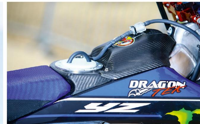
Petit focus sur le réservoir carbone de 12 litres spécialement développé pour les courses de sable. Il dispose d'une valve spéciale pour assurer des ravitaillements rapides et sécurisés.
