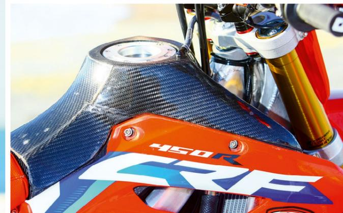
Contrairement à l'YZ-F qui, avec son architecture, n'est pas obligée d'avoir un réservoir carbone surélevé, c'est le cas sur la CRF avec ce modèle Inside Parts. Vous noterez aussi la grosse valve pour ravitaillement rapide.
